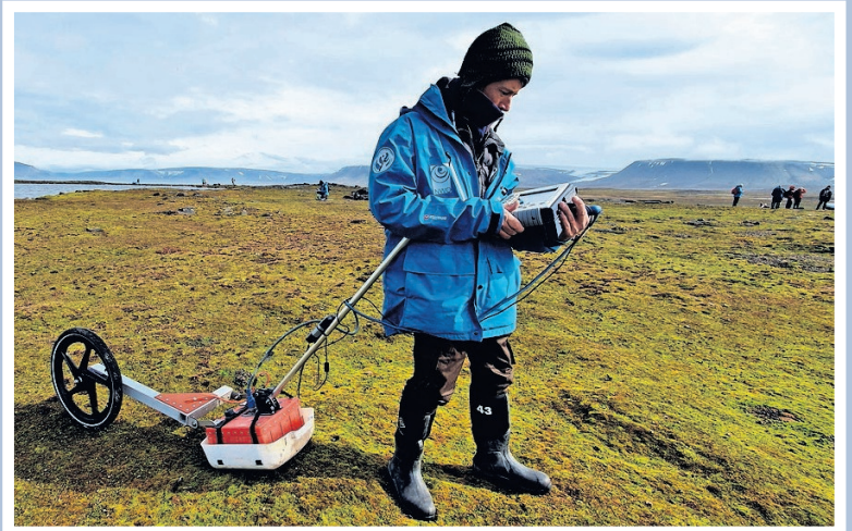
Wouter Rooke gebruikt een mobiel radarapparaat om de diepte van de permafrostlaag te meten. FOTO'S GOVERT SCHILLING
